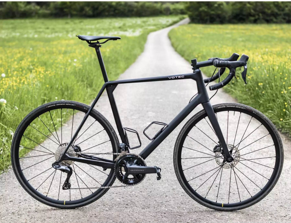
Aufnahmen für Schutzbleche an Gabel und Hinterbau machen das VRC fix wetterfest.
